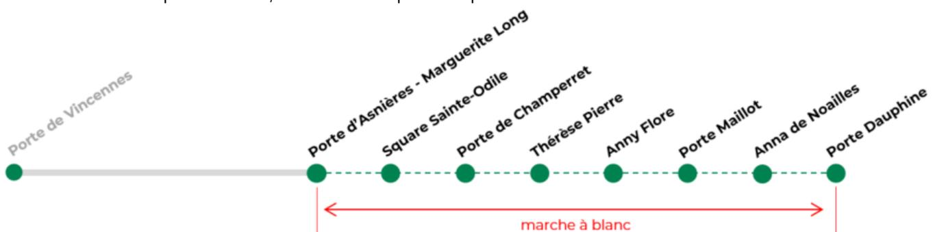
De la Porte d'Asnières à la Porte Dauphine, le tramway circulera **sans voyageurs à bord et sans ouverture des portes**. L'objectif de la **marche à blanc** est de vérifier le bon fonctionnement de l'exploitation et de la signalisation lumineuse de trafic (SLT) du tramway avant la **mise en service prévue le 5 avril 2024**.
